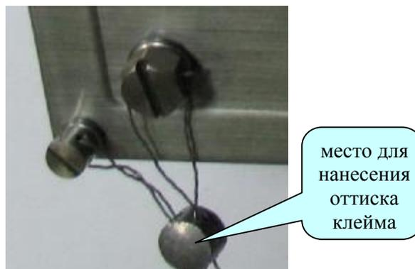
Рисунок 5 Схема защиты от несанкционированного доступа в настройки индикаторов СИ-2001А, СИ-2400BS и обозначение места для нанесения оттиска клейма.
