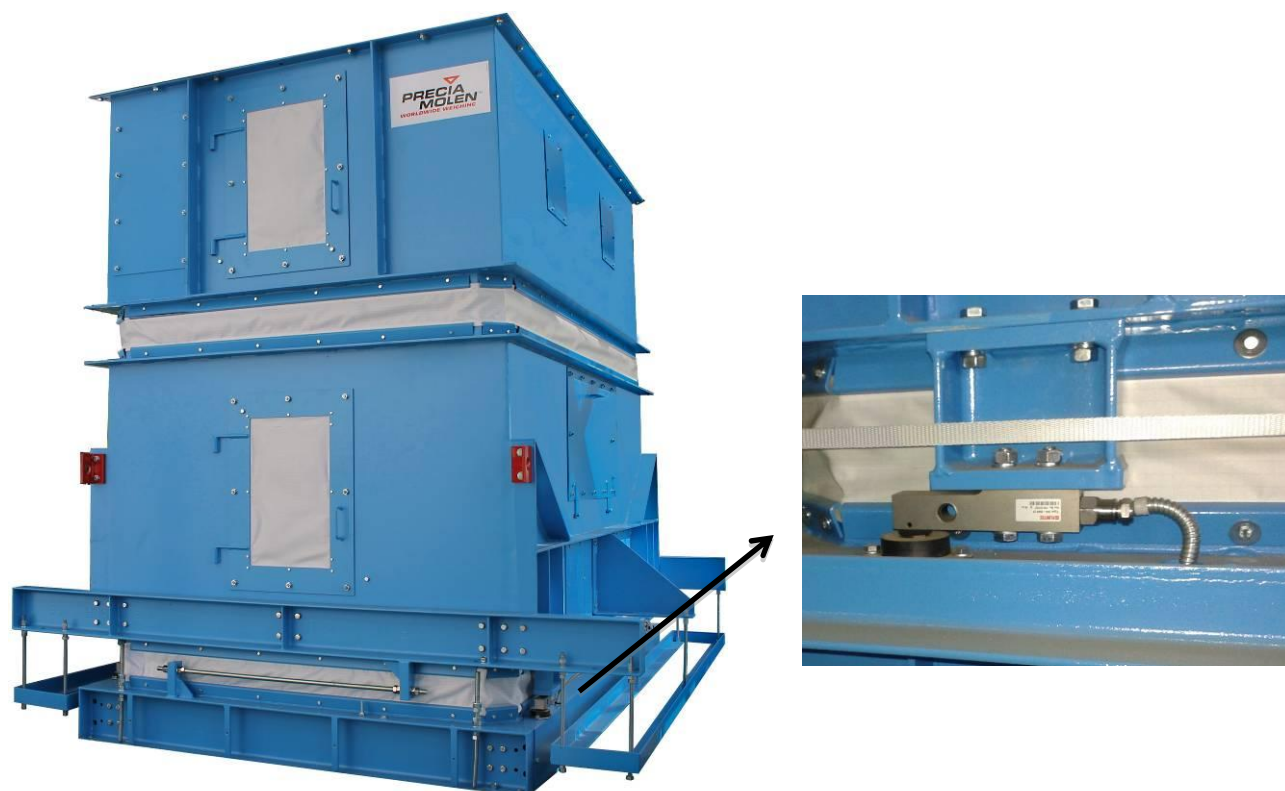
Рисунок 2 – Внешний вид весов ABS-XL (с местом установки датчика).
