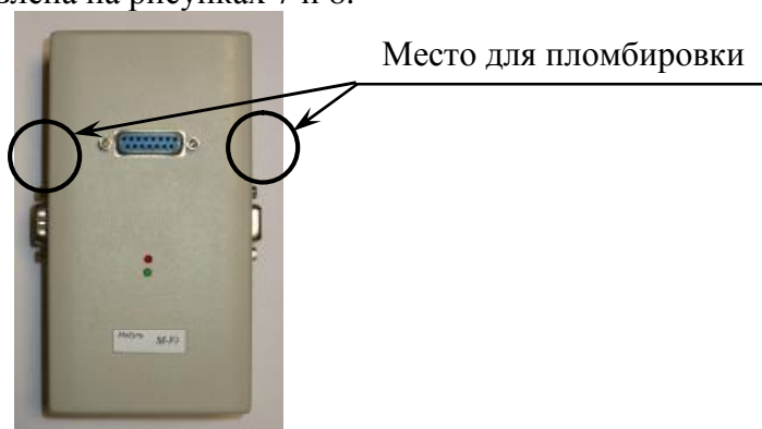
Рисунок 7. Схема пломбировки измерительных модулей
