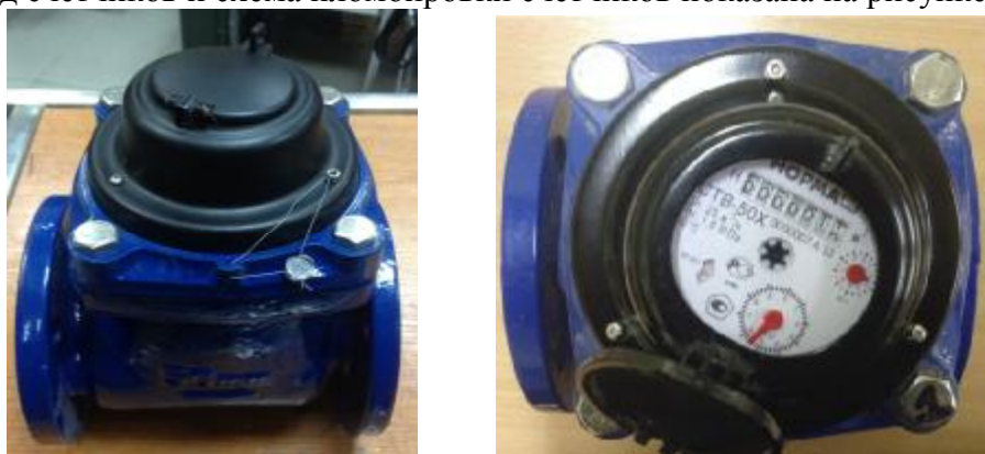
Рисунок 1. Общий вид и схема пломбировки счетчиков.
