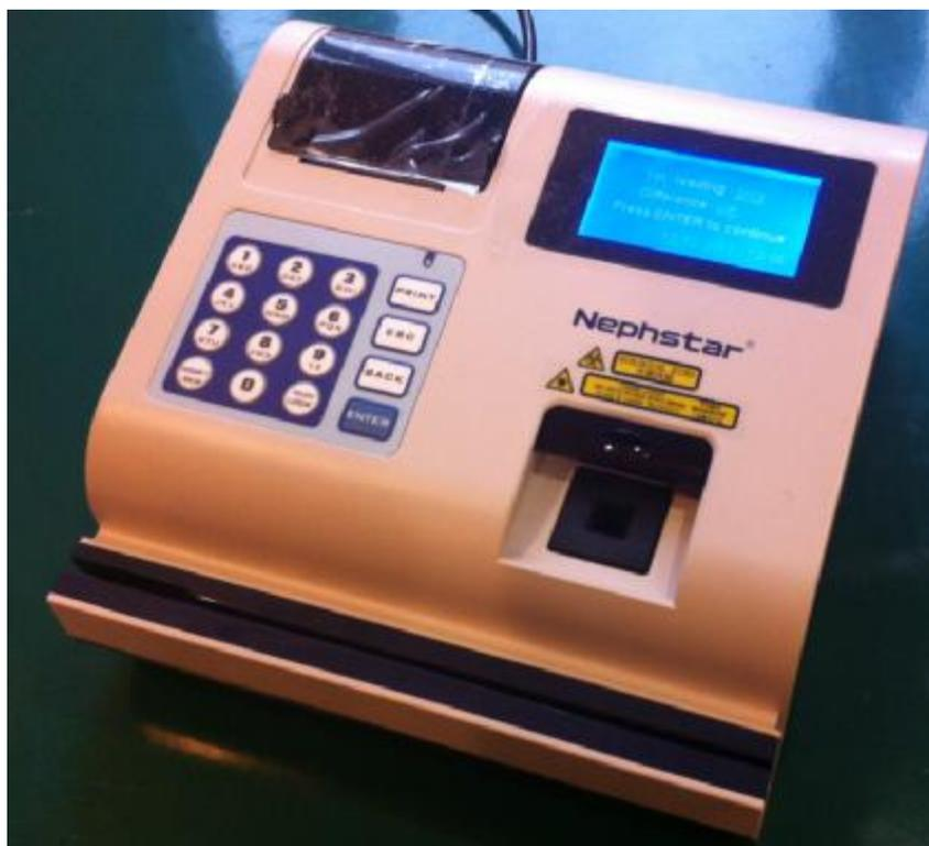
Рисунок 1 – Общий вид нефелометра модель Nephstar
