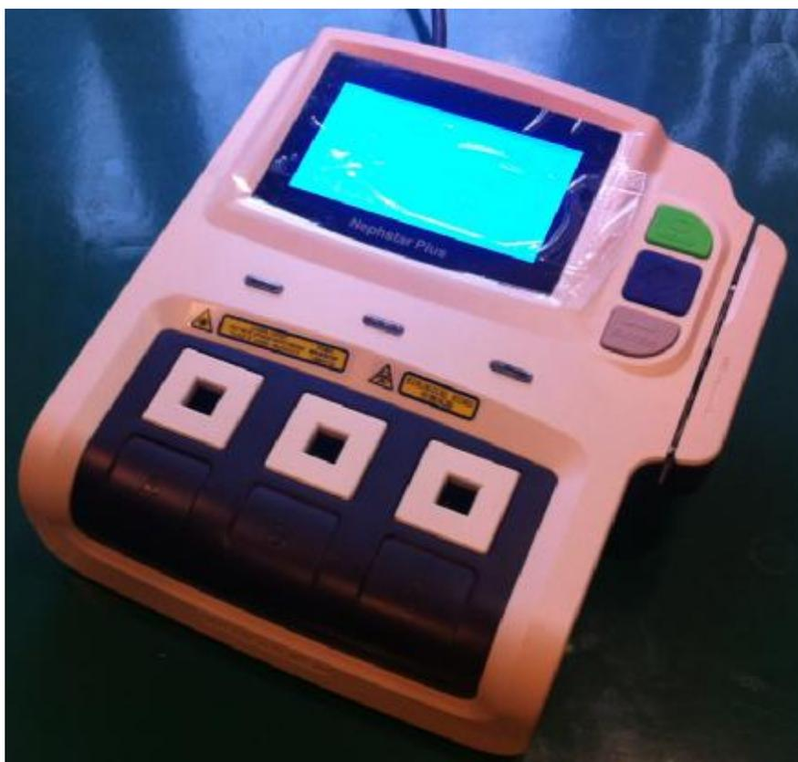
Рисунок 2 – Общий вид нефелометра модель Nephstar Plus
