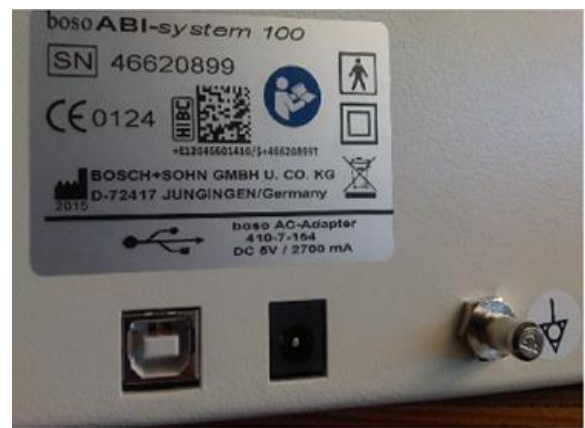
Рис. 2 Маркировка приборов различных вариантов исполнения и разъёмы для подключения блока питания и рабочей станции
