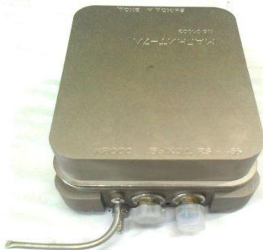
Рисунок 1 – Внешний вид преобразователя Магнит-7Л
