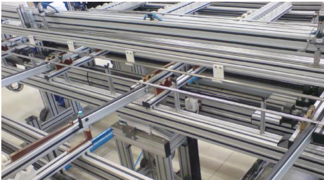
Рисунок 1 Общий вид установки измерения массы
