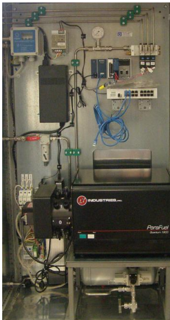
Рисунок 2. Поточная модификация анализатора нефти и нефтепродуктов LT NIR Analyzer
