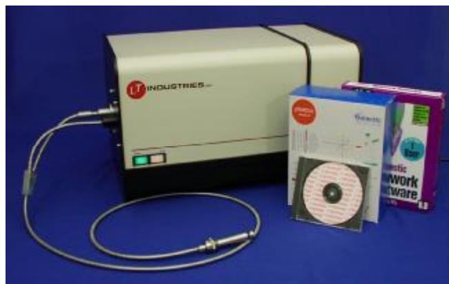
Рисунок 1. Лабораторная модификация анализатора нефти и нефтепродуктов LT NIR Analyzer
