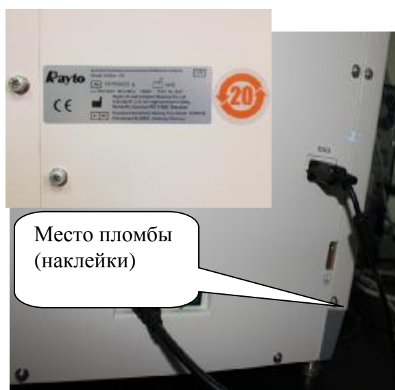
Рисунок 2 – Расположение пломбы (наклейки) Анализатор автоматический биохимический модель VitaRay-420.
