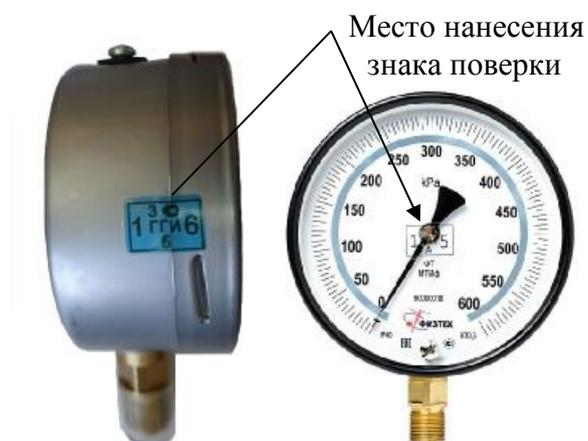
Рисунок 12 - Место нанесения знака поверки
