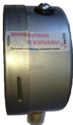
Рисунок 11 - Заводская пломбировка с помощью наклейки
