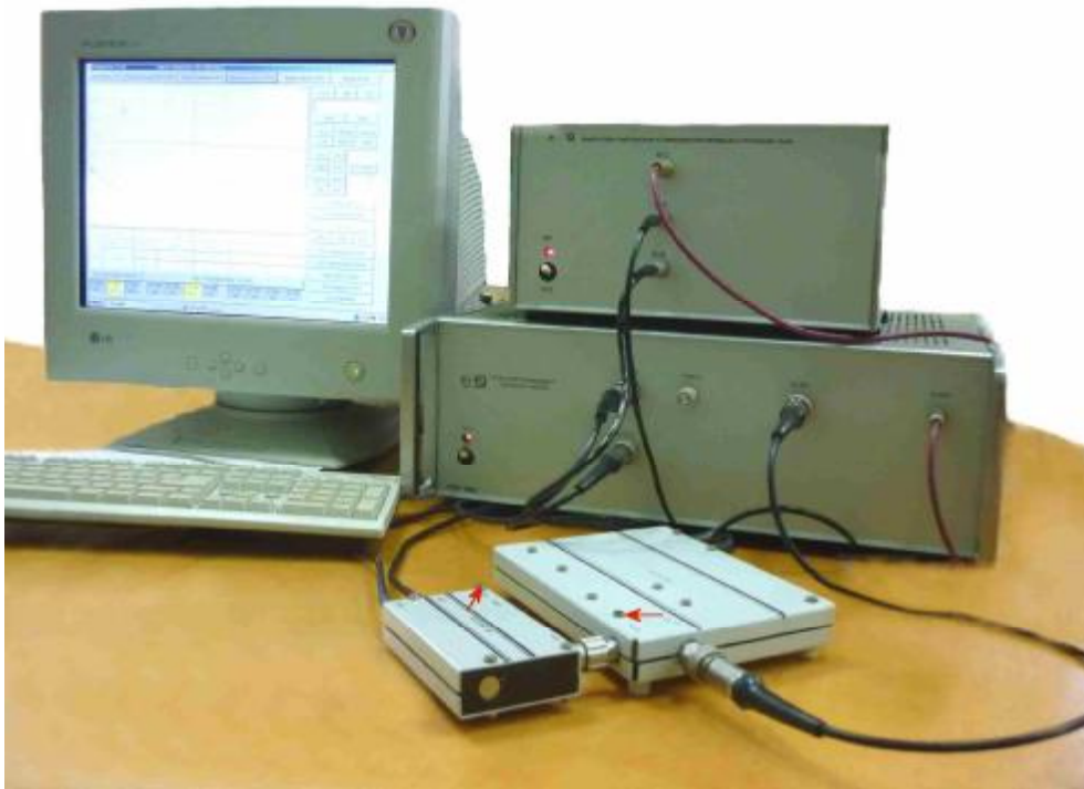
Рисунок 1 – Внешний вид измерителей комплексных коэффициентов передачи и отражения Р4-69
