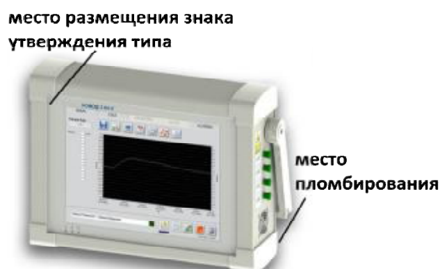
Рисунок 7 – Внешний вид АСВОД УОВОД 2 04-3 с указанием места пломбирования и размещения знака утверждения типа
