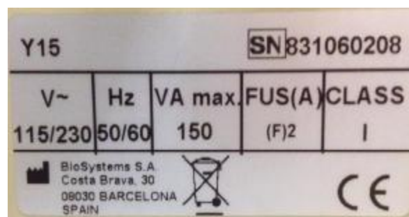
Рисунок 3 – Табличка с маркировкой на задней стенке анализатора
