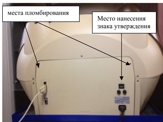
Рисунок 2 – Схема маркировки и пломбирования (задняя стенка)
