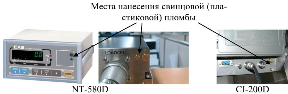
Рисунок 5 – Схема пломбировки приборов весоизмерительных
