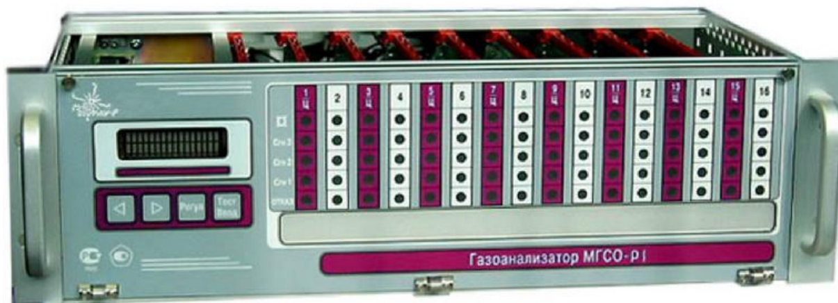
Рисунок 4 – Внешний вид «Терминал-А» газоанализаторов стационарных оптических МГСО-Р1
