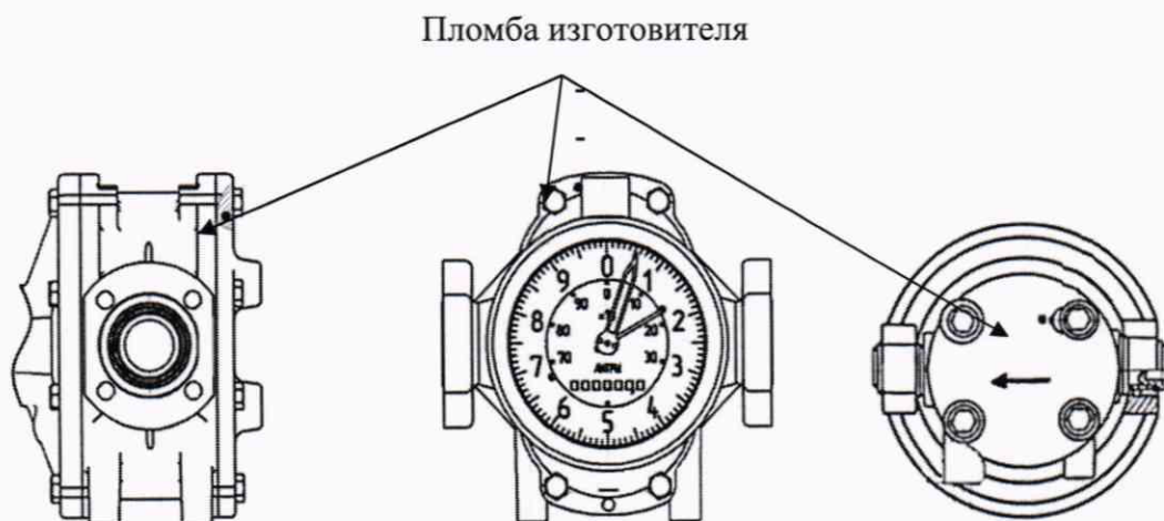
Рисунок 1 – Схемы пломбировки ППО
