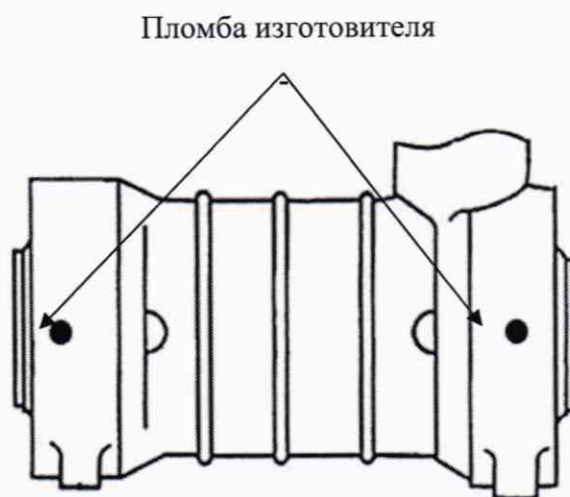
Рисунок 2 – Схема пломбировки ППВ
