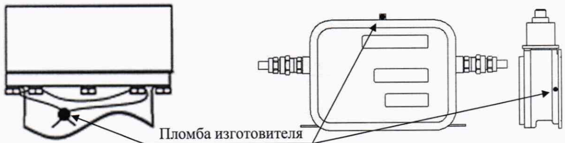
Рисунок 8 – Схема пломбировки ВП КУП+УСС
