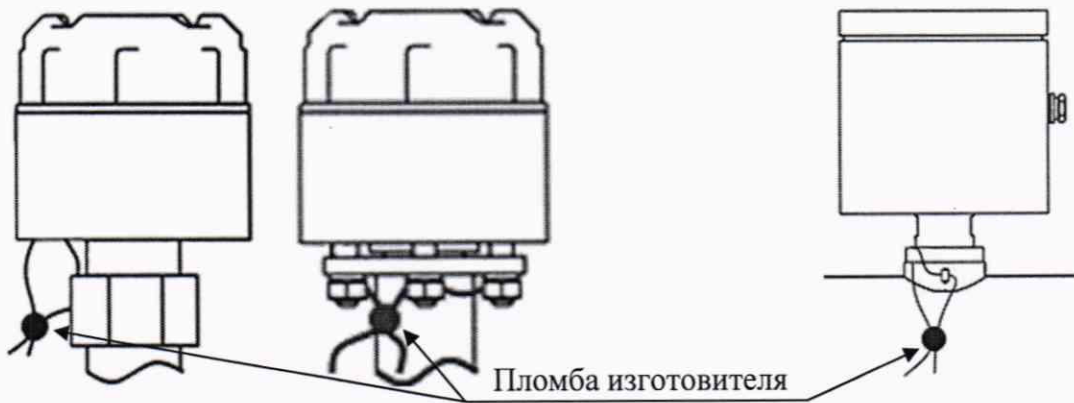
Рисунок 6 – Схема пломбировки ВП ЛУЧ-01 и ЛУЧ-02
