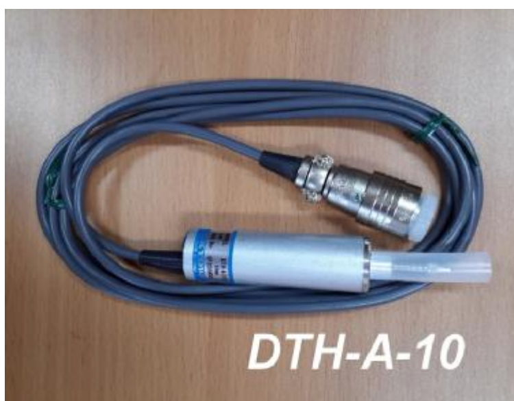
Рисунок 4 – Общий вид датчика DTH-A-10 (увеличено).
