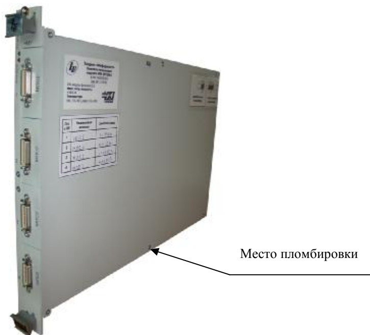
Рисунок 4 – Внешний вид носителя мезонинных модулей НМ-М с установленными магазинами
