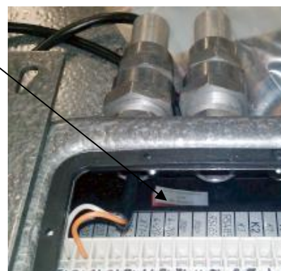
Рисунок 18 – Схема пломбировки вычислителя взрывозащищенного исполнения
