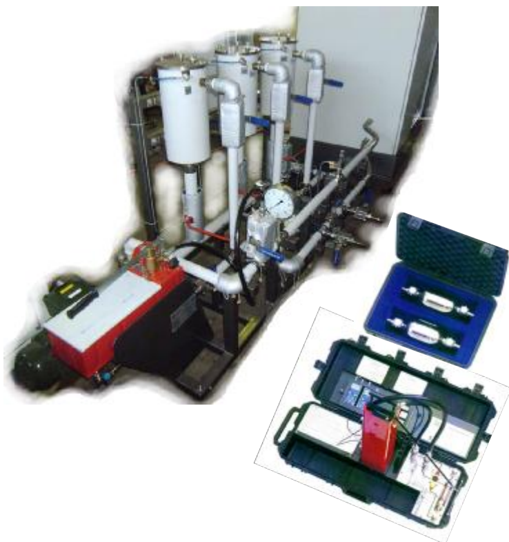
Рис. 1 Технологический блок и пикнометрическая установка
