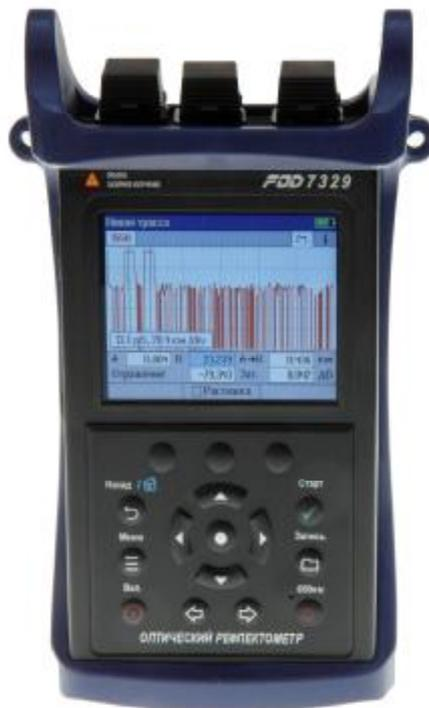
Рисунок 1 - Общий вид рефлектометров оптических моделей FOD-7325, FOD-7328, FOD-7327, FOD-7329
