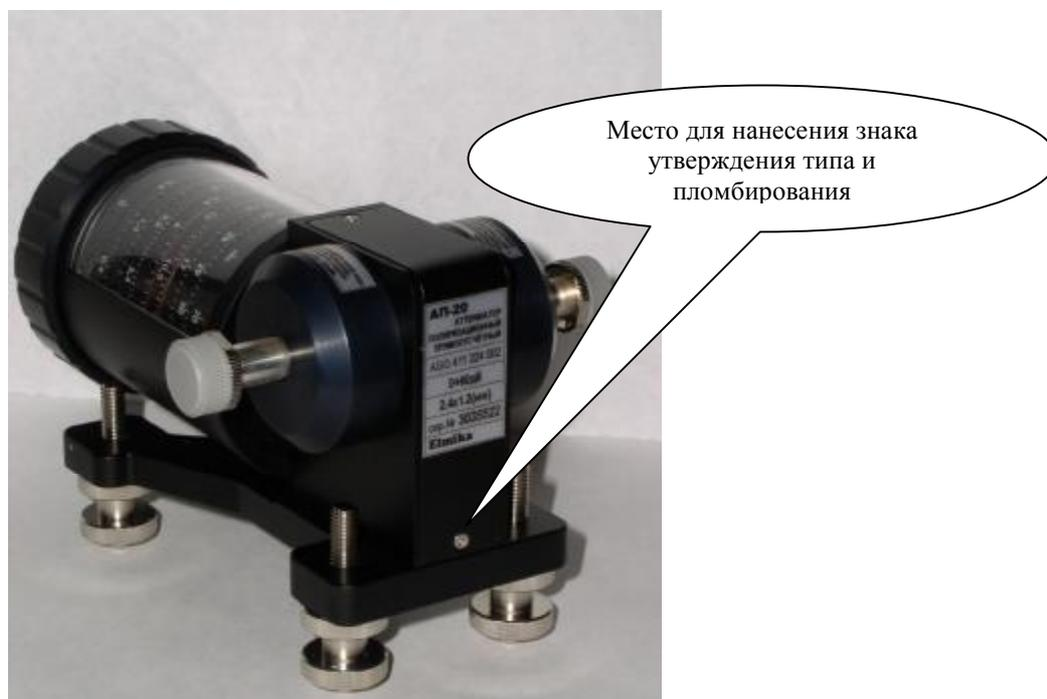
Рисунок 1 - Внешний вид аттенюатора
