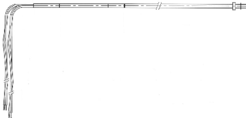
Рис. 1. Внешний вид преобразователя термоэлектрического с двумя термопарами модели 1133-11-694/3\*7000.
