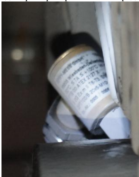
Рис. 1. Термопреобразователь сопротивления платиновый модели 2РТ100/В-20х6-М10х1-2/3.
