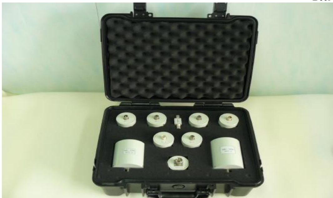
Рисунок 2 Внешний вид ПНТЭ-36-2,5 (ПП1) и блоков добавочных резисторов БДС-3; БДС-10; БДС-30; БДС-50; БДС-100; БДС-300; БДС-500; БДС-1000 модулей составных преобразователей П7-П14.
