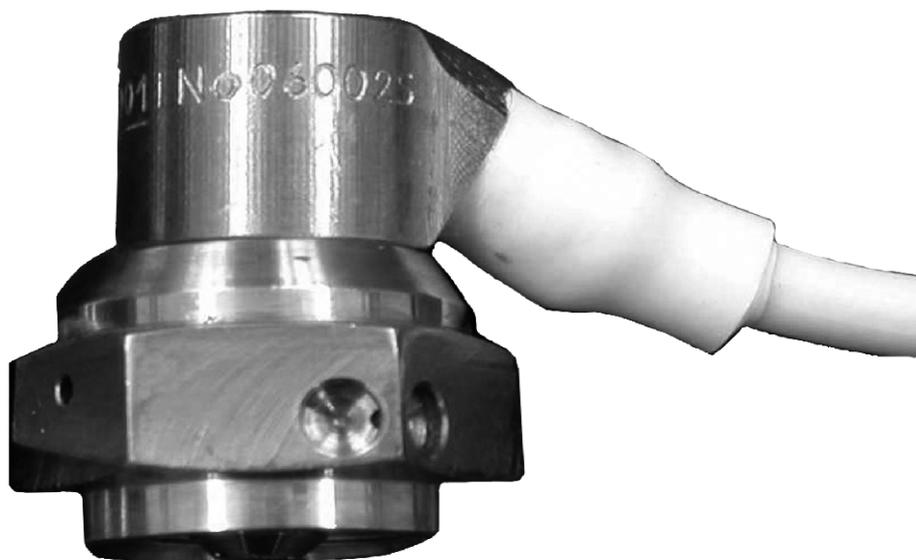
Рисунок 2 – Внешний вид датчика Вм 212А.1
