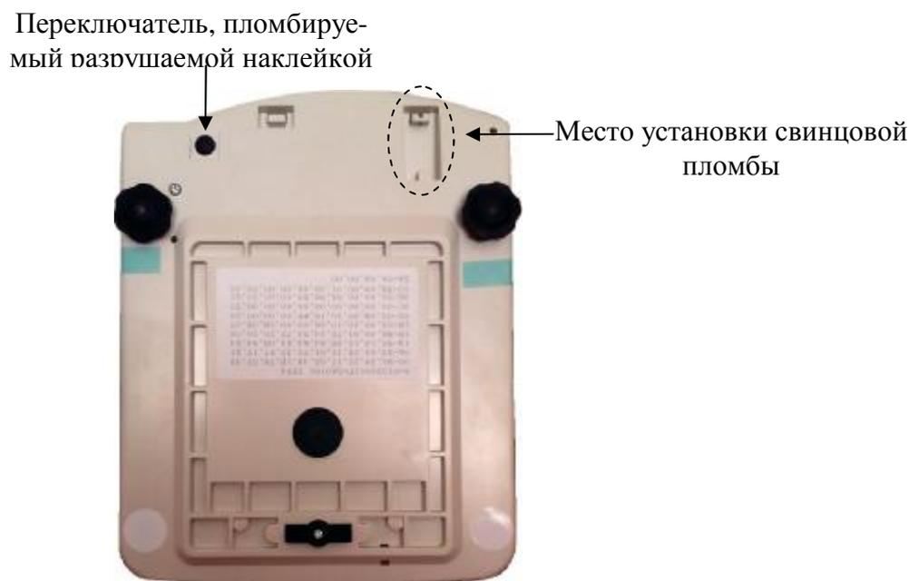
Рисунок 2 - Схема пломбировки весов от несанкционированного доступа.
