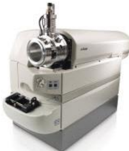
Рис. 1 Внешний вид масс-спектрометров «API 3200», «3200 QTRAP».
