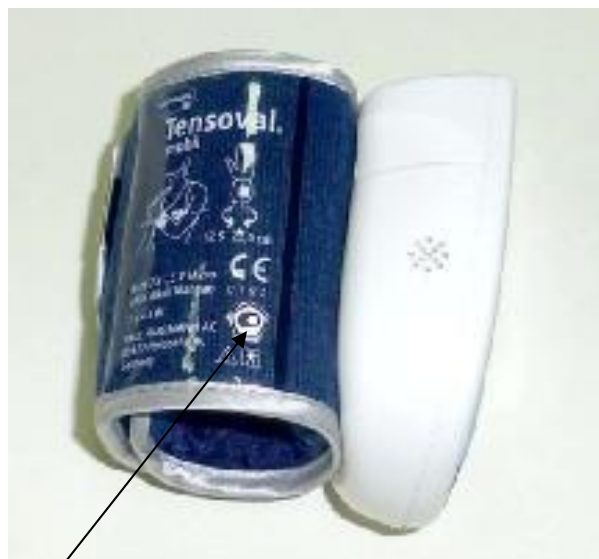
Место нанесения знака утверждения типа. Рисунок 4 Схема маркировки
