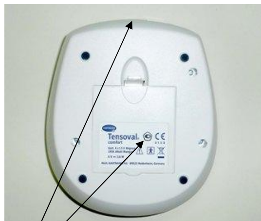
Место нанесения защитной наклейки цифровых от несанкционированного доступа Место нанесения знака утверждения типа. Рисунок 2 Схема маркировки и место нанесения защитной наклейки от несанкционированного доступа.
