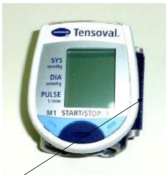
Место нанесения защитной наклейки от несанкционированного доступа.
