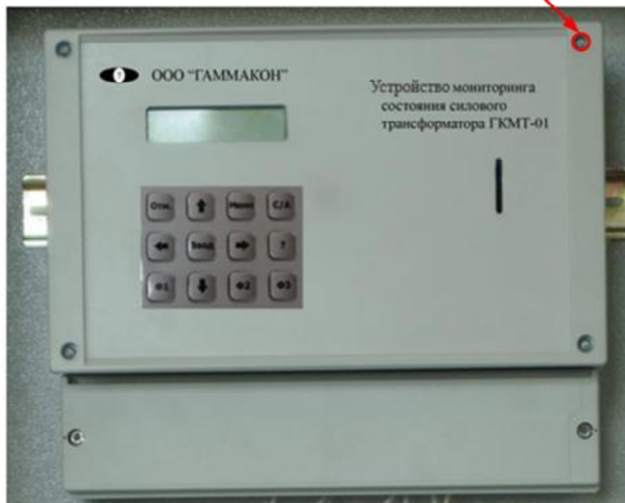
Рисунок 3. Места пломбировки устройства ГКМТ-01
