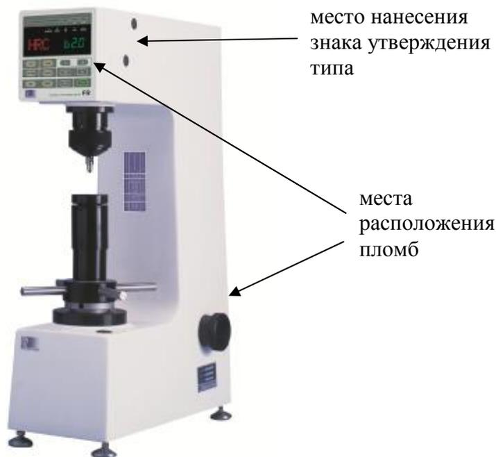
Рисунок 1 – Внешний вид твердомеров
