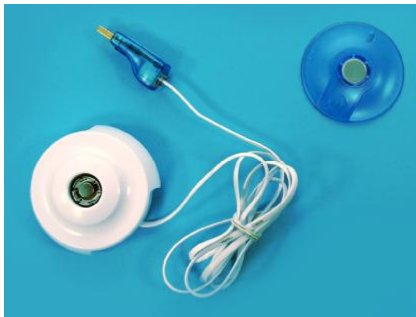
Рисунок 1. Внешний вид комплекса для регистрации температуры «Термолог-Транс» (Thermolog-trans)
