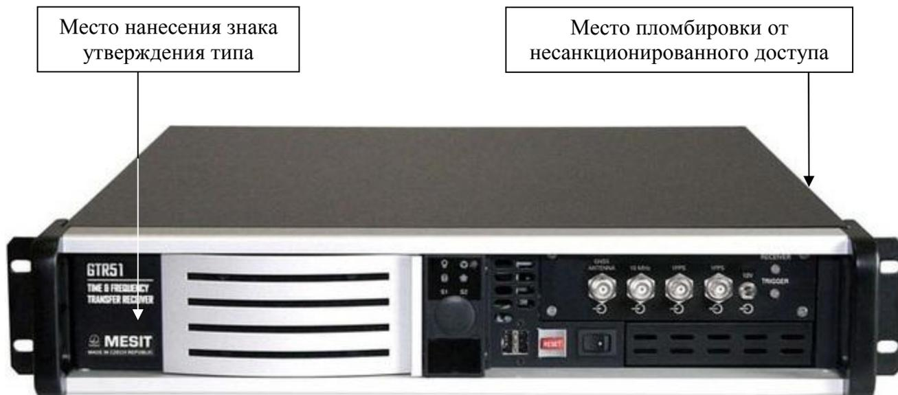
Рисунок 1 – Внешний вид аппаратуры и схема пломбировки
