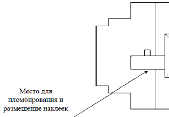
Рисунок 2 – Схема пломбирования контроллеров в пластиковом корпусе
