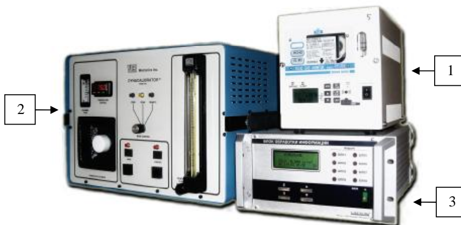
Рисунок 1. Внешний вид комплекса измерительного ФОРТ с блоком градуировки БГ модели 340 фирмы «VICI Metronics Inc.»
