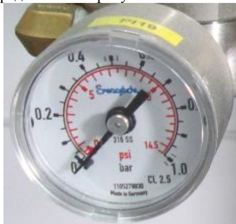
Рисунок 1. Манометр показывающий модели PGI-40M-BG1-CANX.
