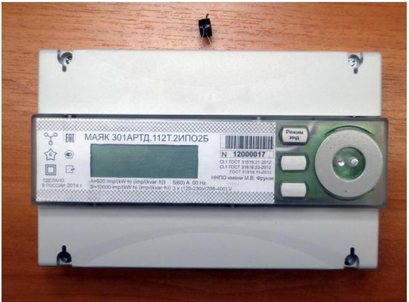
Рисунок 1 – Внешний вид счетчика с закрытыми крышками
