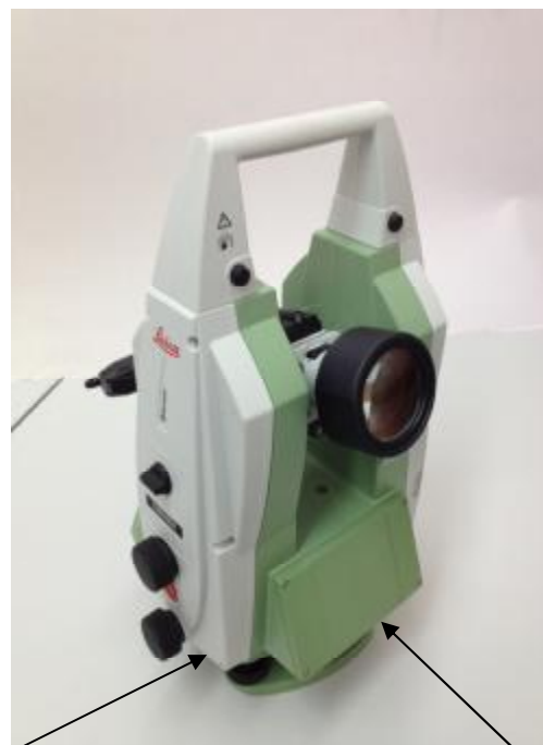
Рисунок 2 – Вид теодолита со стороны передней панели а – место пломбировки б – место нанесения наклейки со знаком утверждения типа
