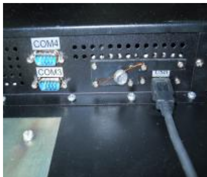
Рисунок 3 –Схема пломбировки БУ
