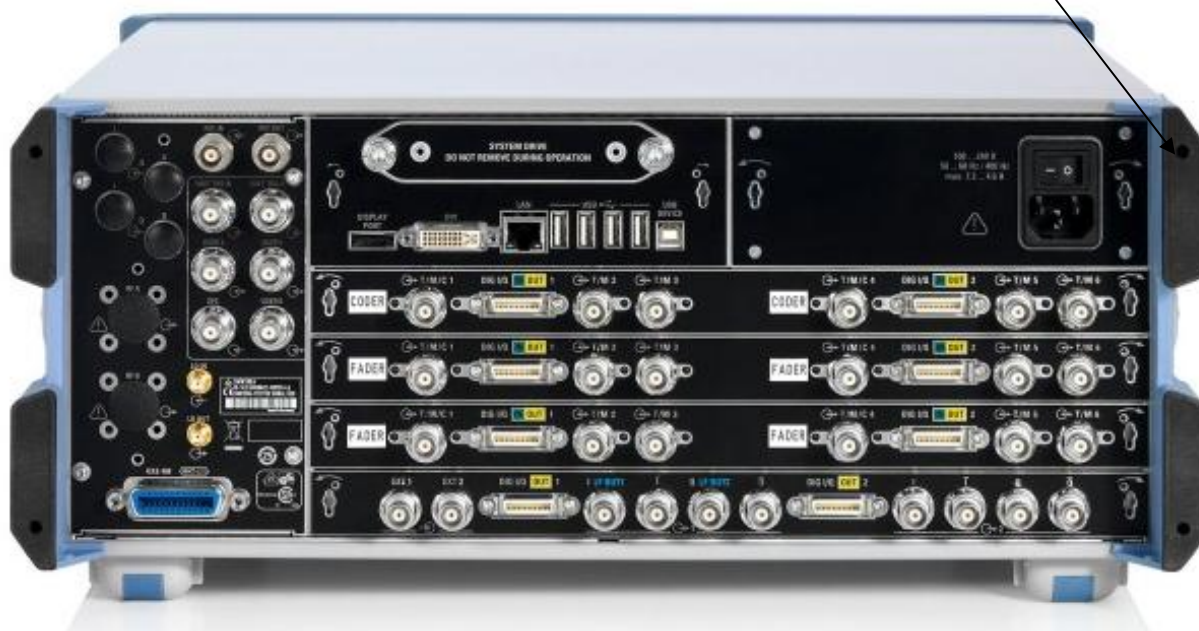
Рисунок 2 - Схема пломбировки от несанкционированного доступа
