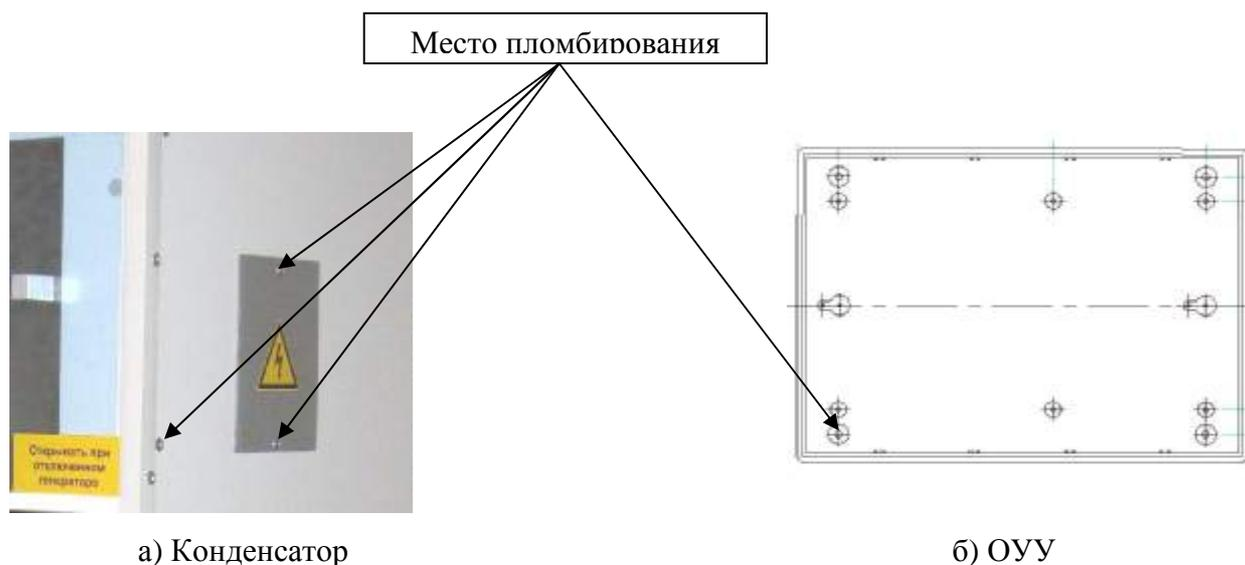
Рисунок 2 – Места пломбирования
