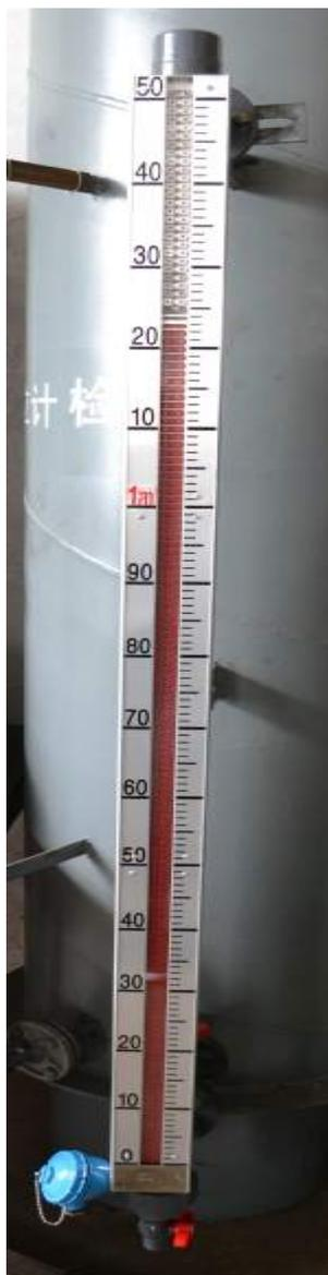
Рисунок 1 — Общий вид уровнемеров магнитострикционных поплавковых YY-UZF и YY-DS
