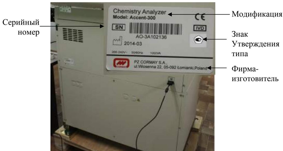
Рисунок 3 – Схема маркировки
