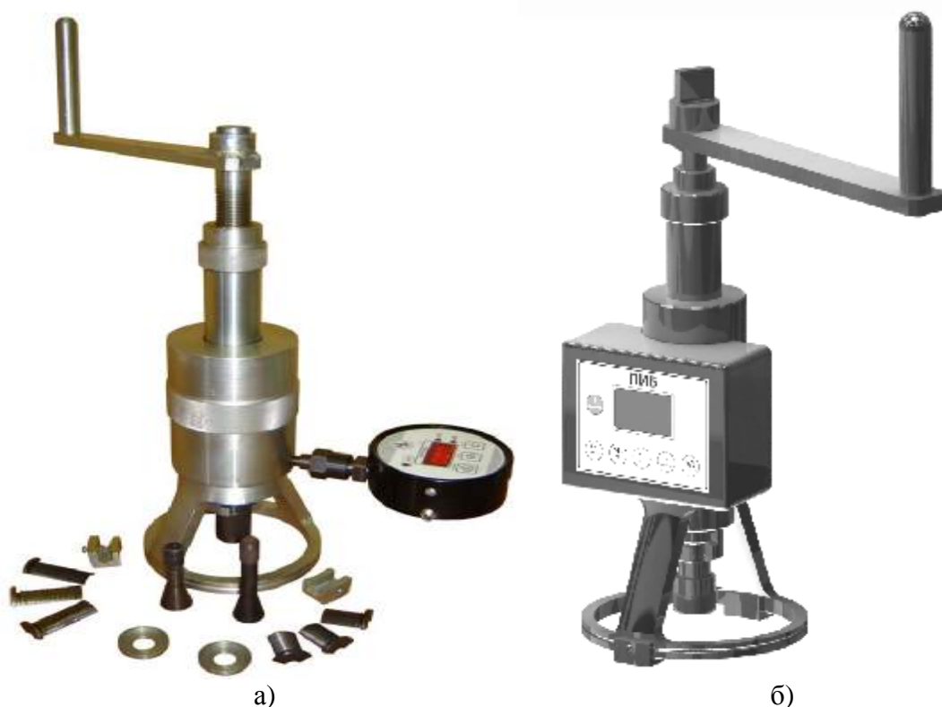
Рис.1 Внешний вид приборов для определения прочности бетона ПИБ а) модификаций ПИБ-40 и ПИБ-70; б) модификаций ПИБ-40М и ПИБ-70М
