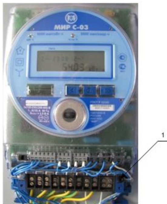
Рисунок 2 – Внешний вид и схема пломбирования прибора на предприятии-изготовителе
