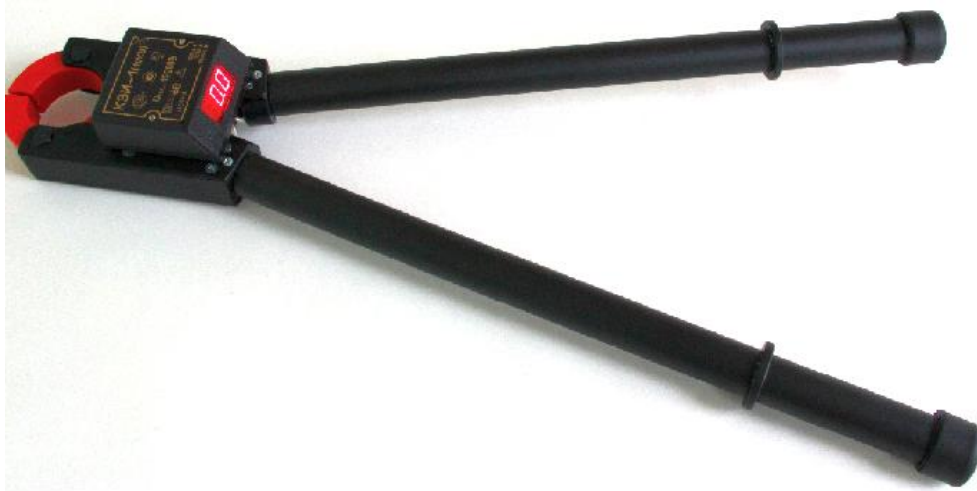
Рисунок 1 - Внешний вид клещей электроизмерительных КЭИ-1(10кВ)
