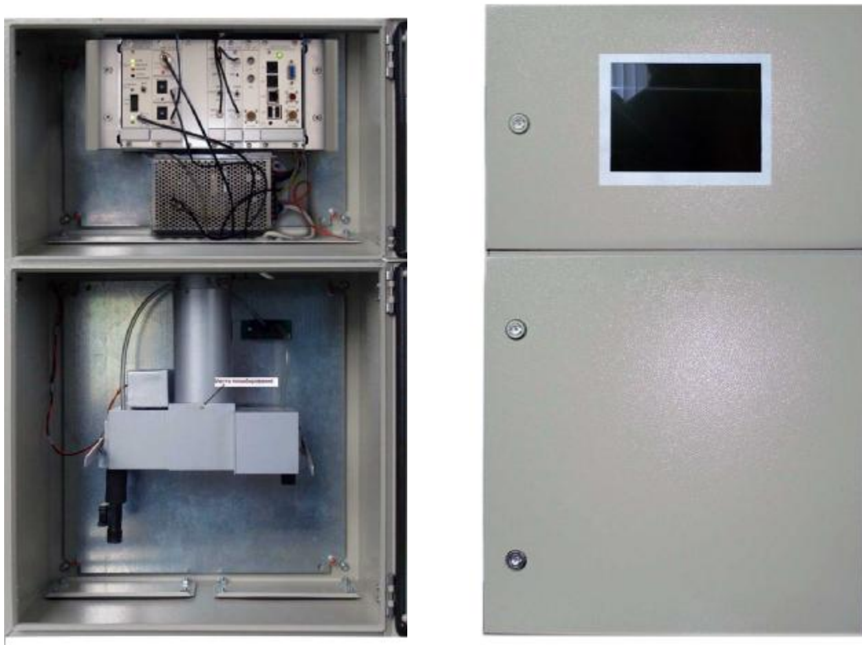
Рис. 1. Фотографии общего вида устройства детектирования объемной активности радиоактивных аэрозолей УДАС-14АЕ «УРАН».
