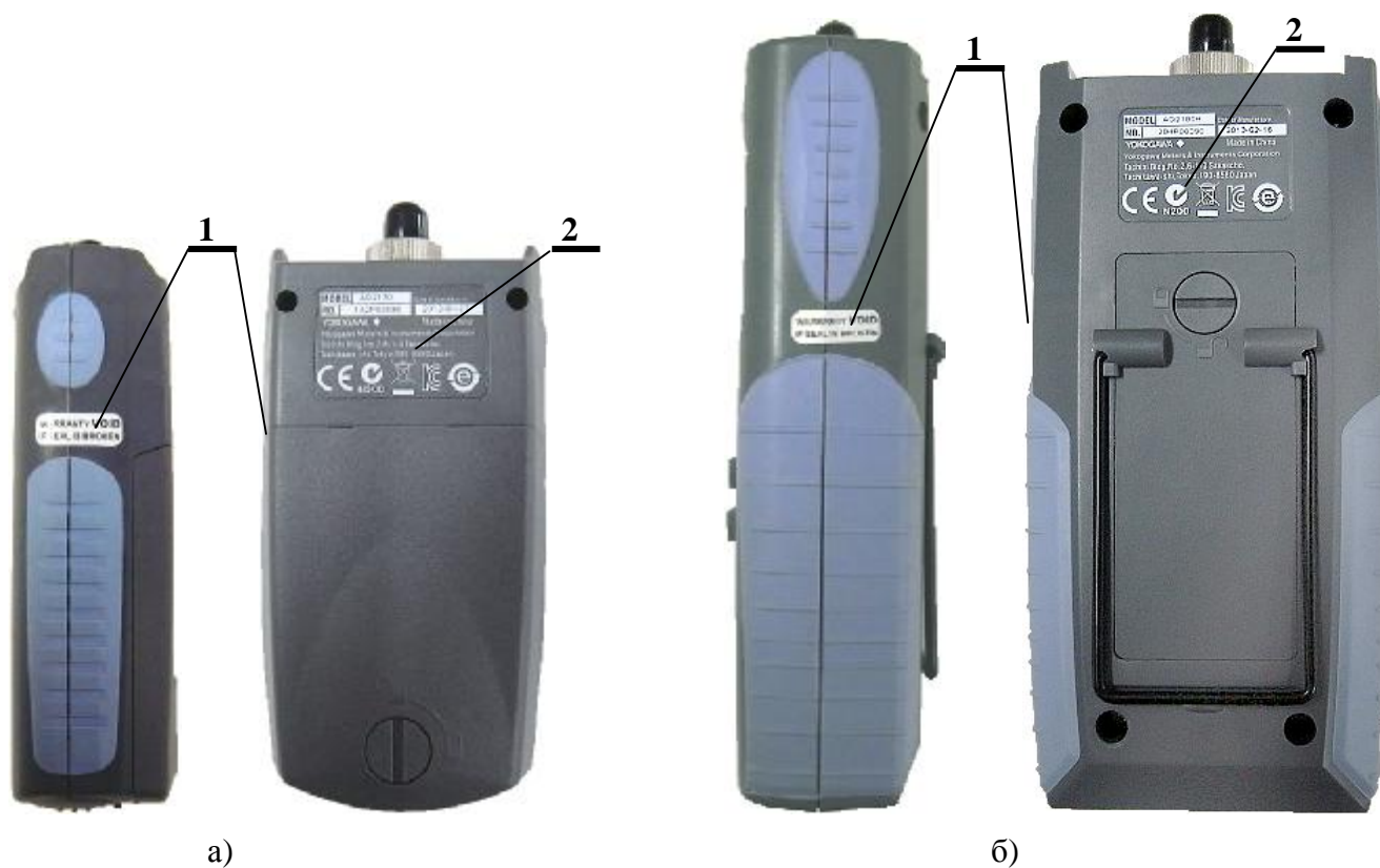
Рисунок 2 - Схема пломбирования и маркировки тестера – вид сбоку и сзади 1 - место нанесения защитной наклейки; 2 - место нанесения маркировки а) - AQ2170; б) - AQ2180 и AQ4280
