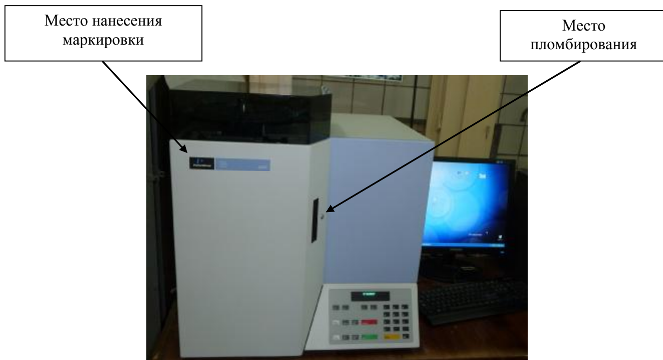
Рисунок 1 – Общий вид системы элементного CHNS анализа PE 2400-II с указанием места нанесения маркировки и места пломбирования
